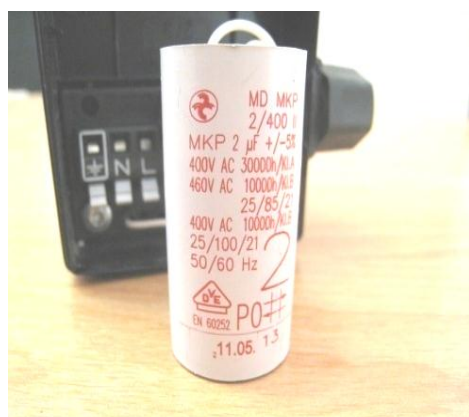
خازن پمپ سیرکولاسیون
